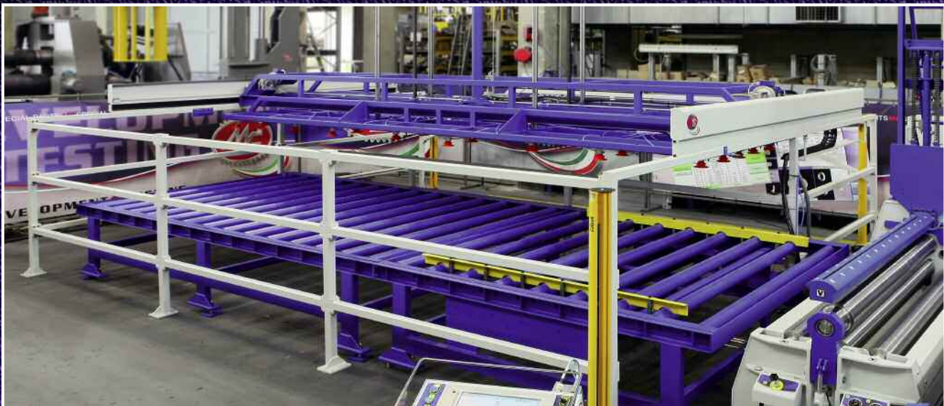
• Impianto automatico con rulliera e caricatore a ventose
