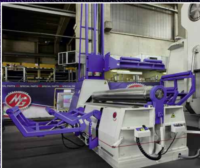
• Supporto verticale a scomparsa e supporto laterale doppio braccio • Vertical retractable support and double arm side support • Support rétractable vertical et support latéral à deux dégagement • Soporte retráctil vertical y soporte lateral de doble brazo
